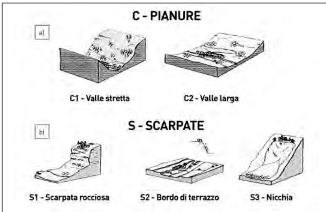
Figura 3.4-3 – Pianure e Scarpate. a) Pianure. Centri urbani o parte di essi che si trovano su una superficie di terreno posta a quota minore rispetto a un intorno relativo (una sezione trasversale del centro risulta approssimabile a una curva concava); b) Scarpate. Parte di centri urbani in prossimità di brusche e nette variazioni di quota del terreno, ad esempio: scarpate rocciose, bordi di terrazzo, nicchie di distacco, ecc. (una sezione trasversale del centro risulta caratterizzata da una linea a inclinazione variabile con brusca variazione di quota).
