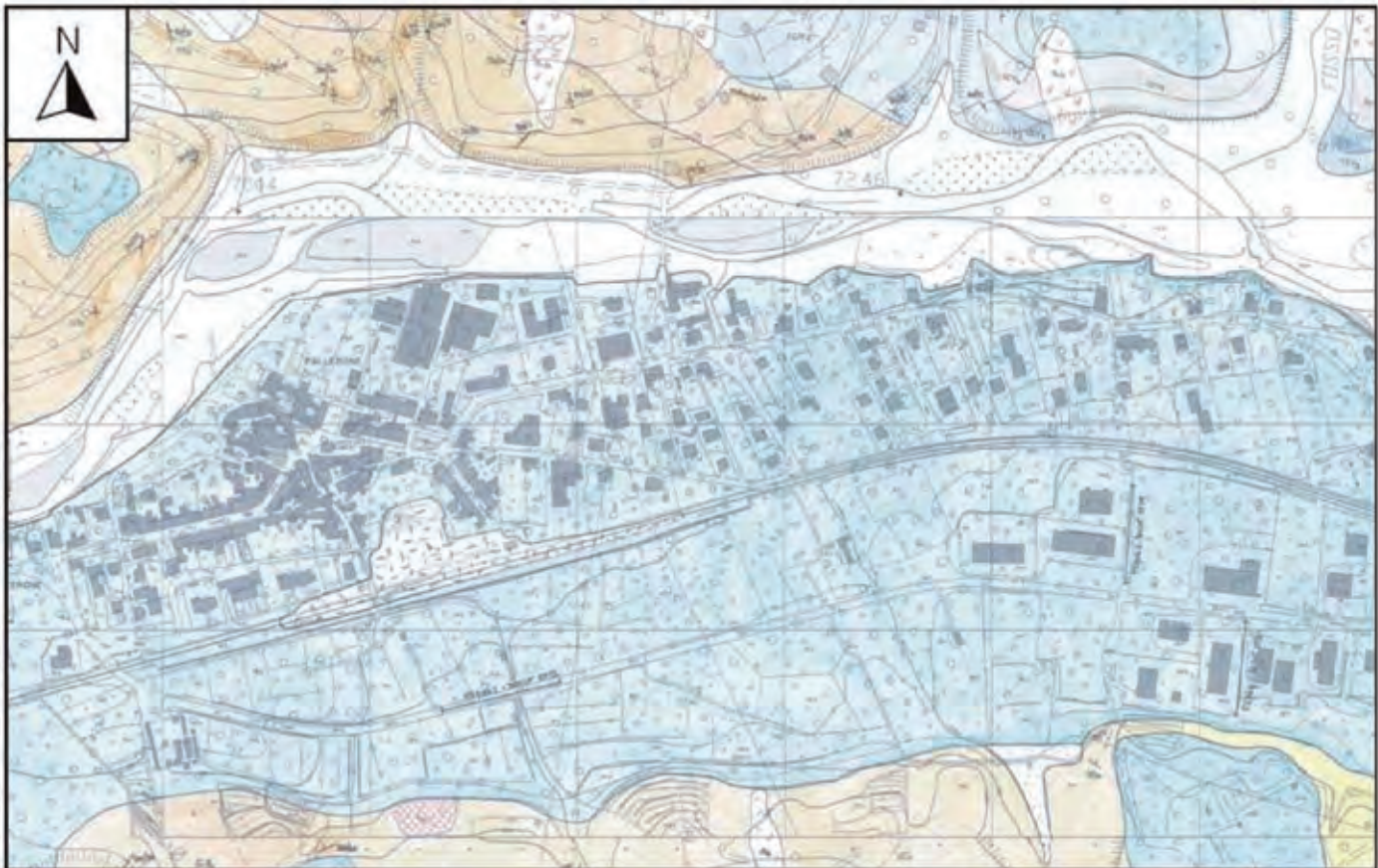
Figura 3.4-5 – Esempio di carta geologica realizzata nell’ambito del progetto VEL (Regione Toscana) da rilievo in scala 1:2.000 (ai fini della rappresentazione nel presente documento la scala è stata ridotta).
