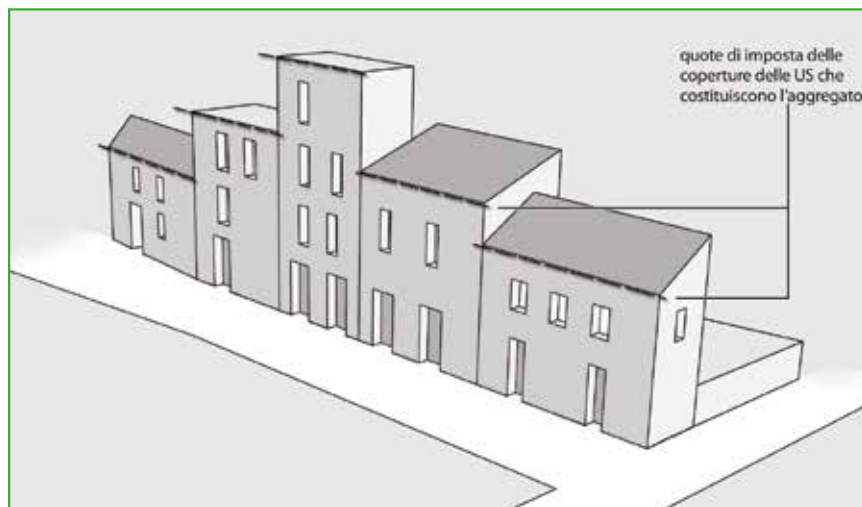
Figura AS 9. Altezza all'imposta delle coperture delle Unità Strutturali.
