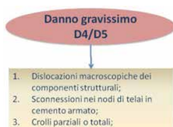
Figura 17. Caratteristiche danno gravissimo D4-D5.
