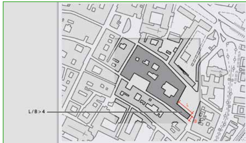
Figura AS 20. Aggregato strutturale con testata snella.
